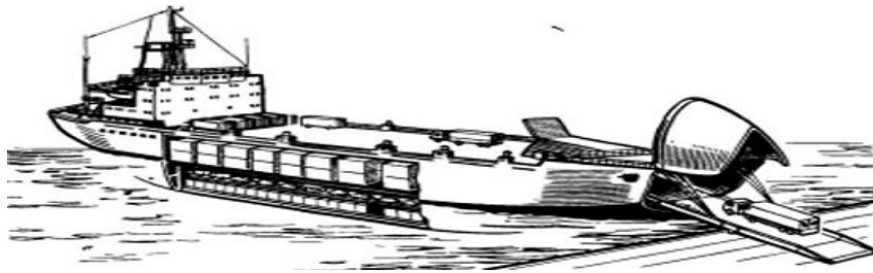
Рис 16. Схема судна с горизонтальным способом грузообработки.
